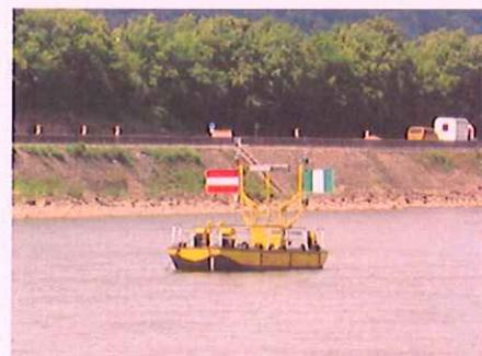
*Ponton de signalisation avec interdiction de passer du côté du panneau rouge et blanc et passage autorisé du côté des panneaux vert et blanc.*
